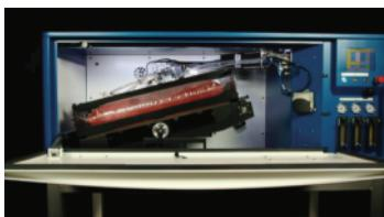
特許2次元振盪方式で培地を上下方向だけでなく左右にも動かすことでKLa値600h-1という高効率の培養を実現
